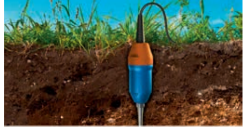
Mit Hilfe solcher Erdmikrophone (Geophone), werden die Schallwellen aus dem Erdinnern empfangen und aufgezeichnet
